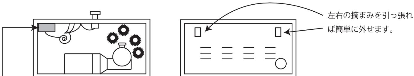
②温度調整器を固定している部品を外します。
