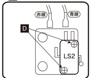
⑦新しい LS2 と交換して、D C B A の順番で、 ネジ・線・バネを戻していきます。
