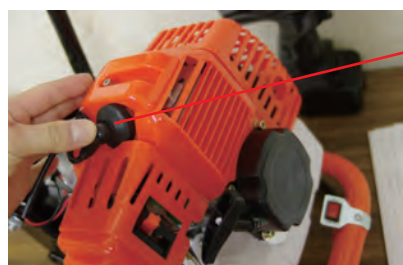
緩んでいないか、しっかり押し込む。
